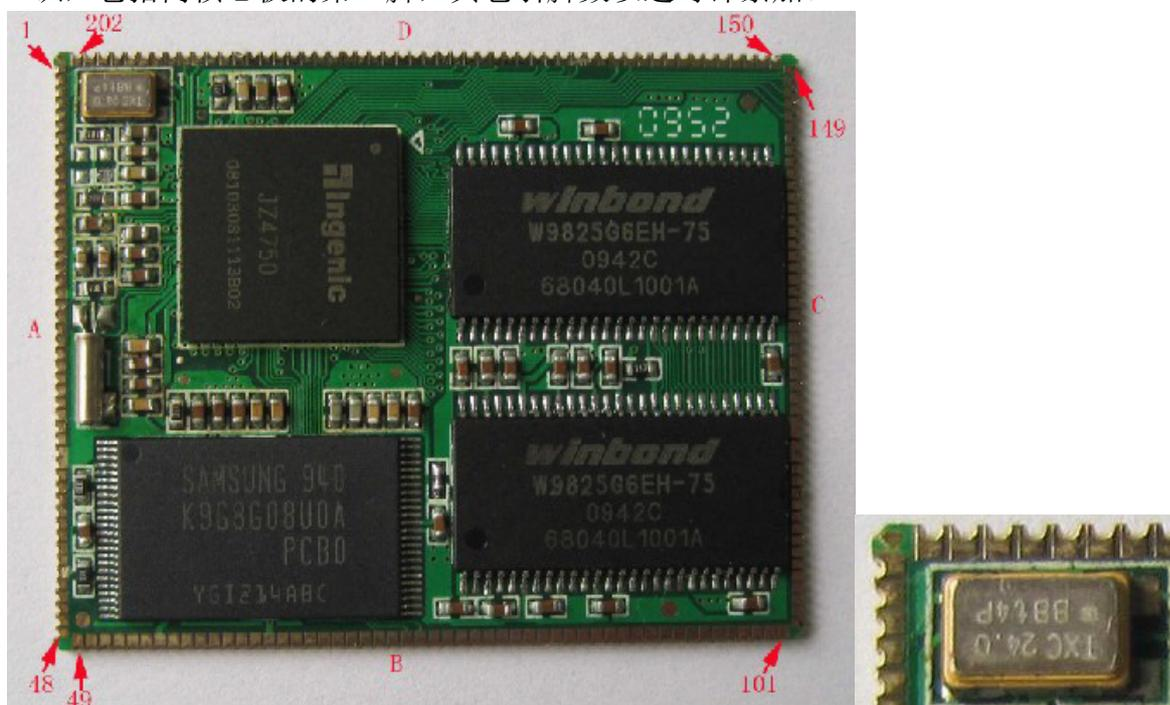
上图中的 A 区及 C 区为 48 个 PIN，其引脚间距为 0.8MM；B 区与 D 区为 53 个 PIN，其引脚间距为 0.9MM。这个核心板应用的 SCH 及 PCB 封装我也都做好了，目前是 Protel 99se 格式的封装。
