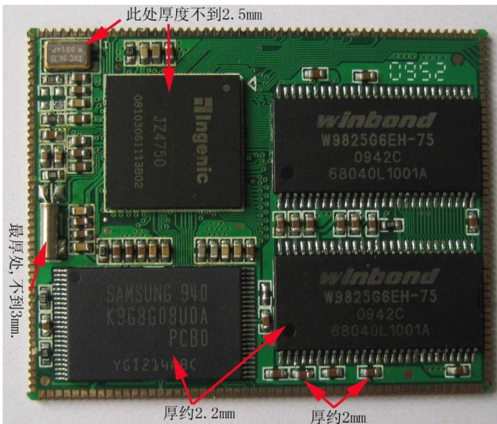
本核心板是四层玻纤板(FR-4)，默认配置是 64M SDRAM，1G NAND(型号是 K9G8G08U0A)，核心板支持 128M SDRAM，背面还可以焊上两片 32M 的 SDRAM，如下图：
