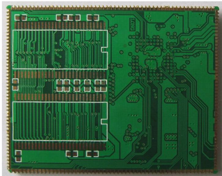
这里背面的 0603 元件均为 0.1uF 电容。如果你焊上了背面 SDRAM，底板的设计上应该在相应的位置上挖出孔来，这个孔的位置我有做在“JZ4750-CORE 应用”中的 PCB 封装中，可以参考使用。
