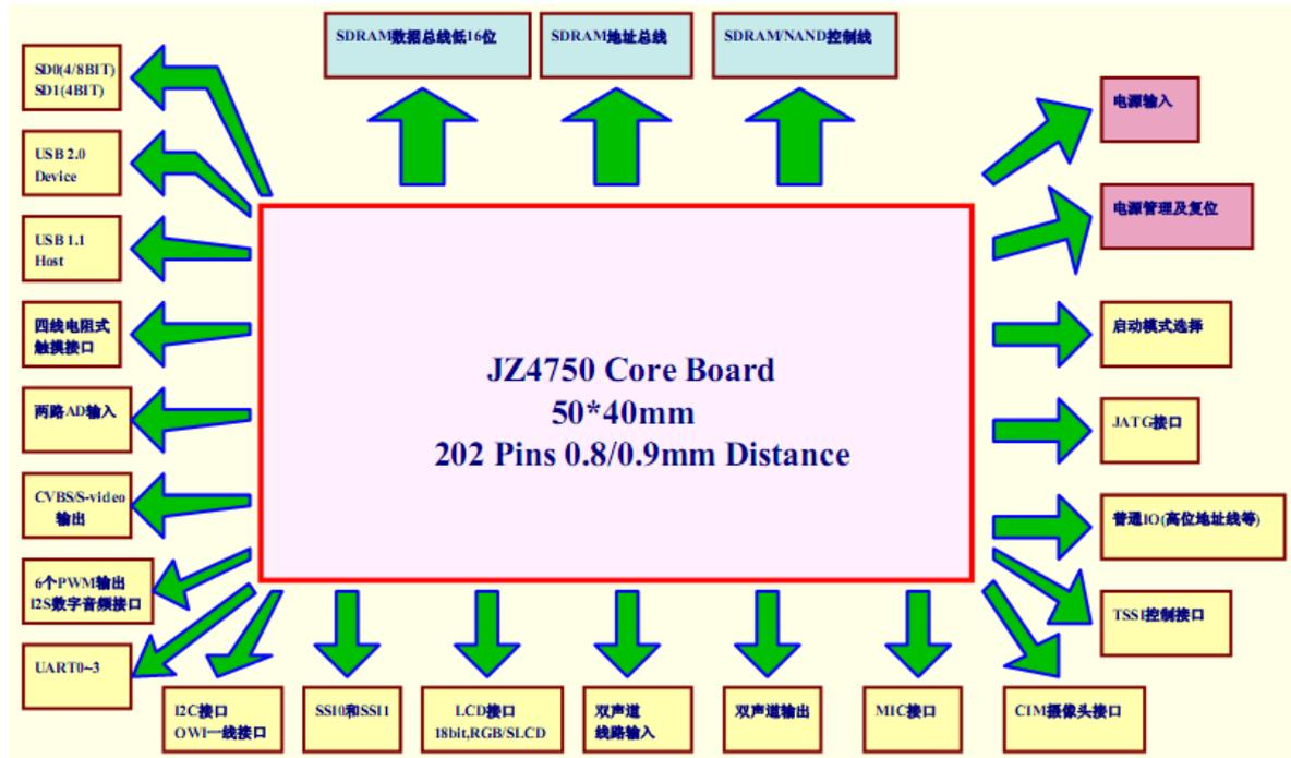
它总共有 202 个 PIN，最大外形尺寸为 50\*40mm，PCB 板厚度 1.00mm(样板为 1.2mm)，加上各元件的总厚度如下图所示：
